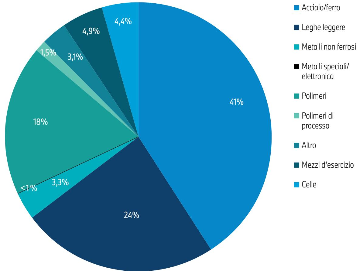
Fig. 2: composizione dei materiali della BMW 530e Touring all'inizio della produzione. I valori indicati possono presentare differenze di arrotondamento.
